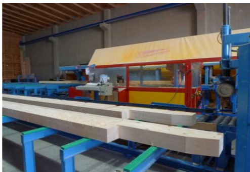
↑フンデガーのプレカット加工機で躯体を加工する工場↓
